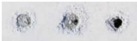
5. ábra. Robbantással átütött kráterek. Nyitott, félig visszahullott jégdarabokkal kitöltve és helyben maradt jégdarabokkal kitöltve
