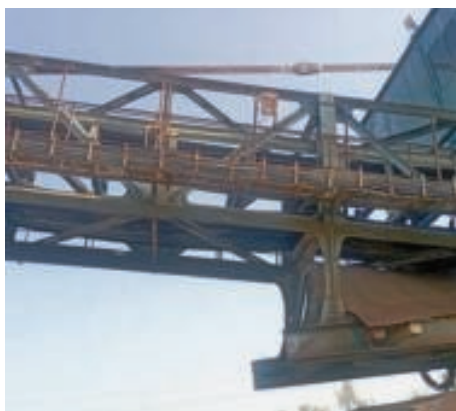
13. ábra. A köztes szalag segédgép felőli felfüggesztési pontja (a szerzők felvétele)
