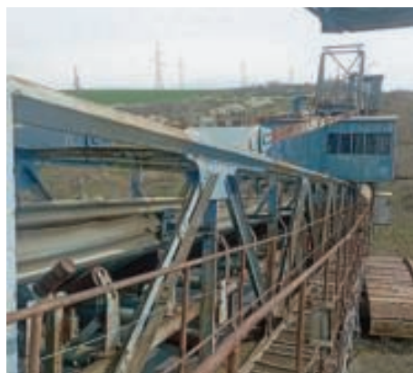
14. ábra. A köztes szalag főgép felőli felfüggesztési pontja a szociális bódéhoz (a szerzők felvétele)
