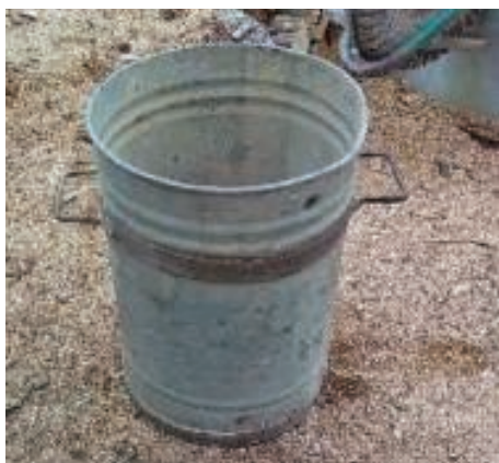
6. ábra. Mosófazék mint kísérleti jégrobbantó perforátor (a szerző birtokában)
