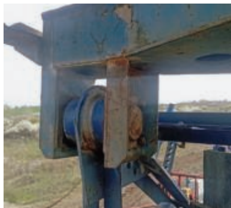
12. ábra. A köztes szalag főgép felőli felfüggesztési pontja (a szerzők felvétele)
